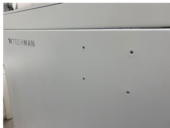
图 3 - 5: 示教器支架安装
